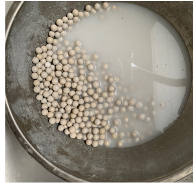
Figure 4 - Média neutralisant après rinçage à l'eau claire
